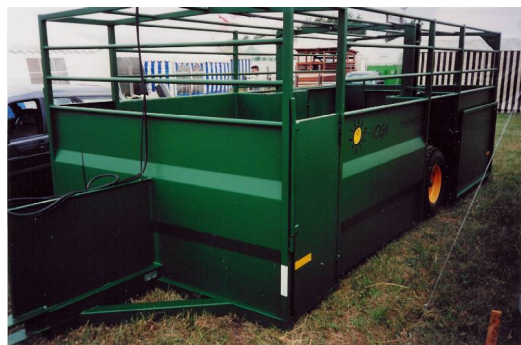
Abb. 6: Hydraulisch absenkbarer Transportwagen; Foto: A-Hyppen
